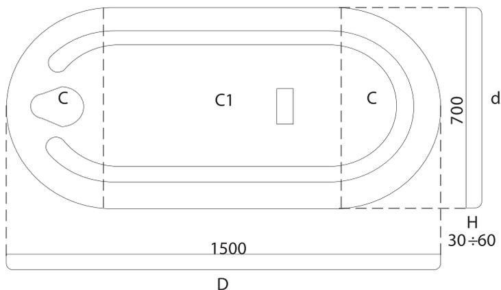
Questo fondo, stampato con una idonea nervatura che ne aumenta la robustezza anche a bassi spessori, viene costruito in lamiera di prima scelta e in acciaio inox (a richiesta). La rifilatura effettuata dopo lo stampaggio permette anche, a richiesta, la possibilità di realizzare la bordatura ad invito
